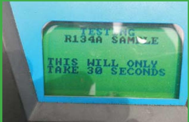
Verificación de la muestra con el equipo analizador.
